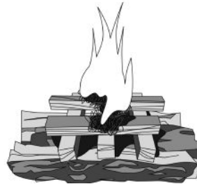
AFB. 4.7 Brandende aansteekmodule op de stapel met brandhout
